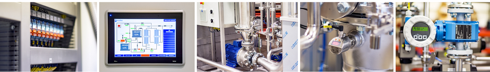
Keramisk ultrafilteranläggning för att rena bort fettemulsioner från vatten
