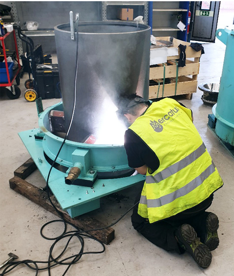
Service och slitagekontroll på spånhanteringssystem hos kund.
