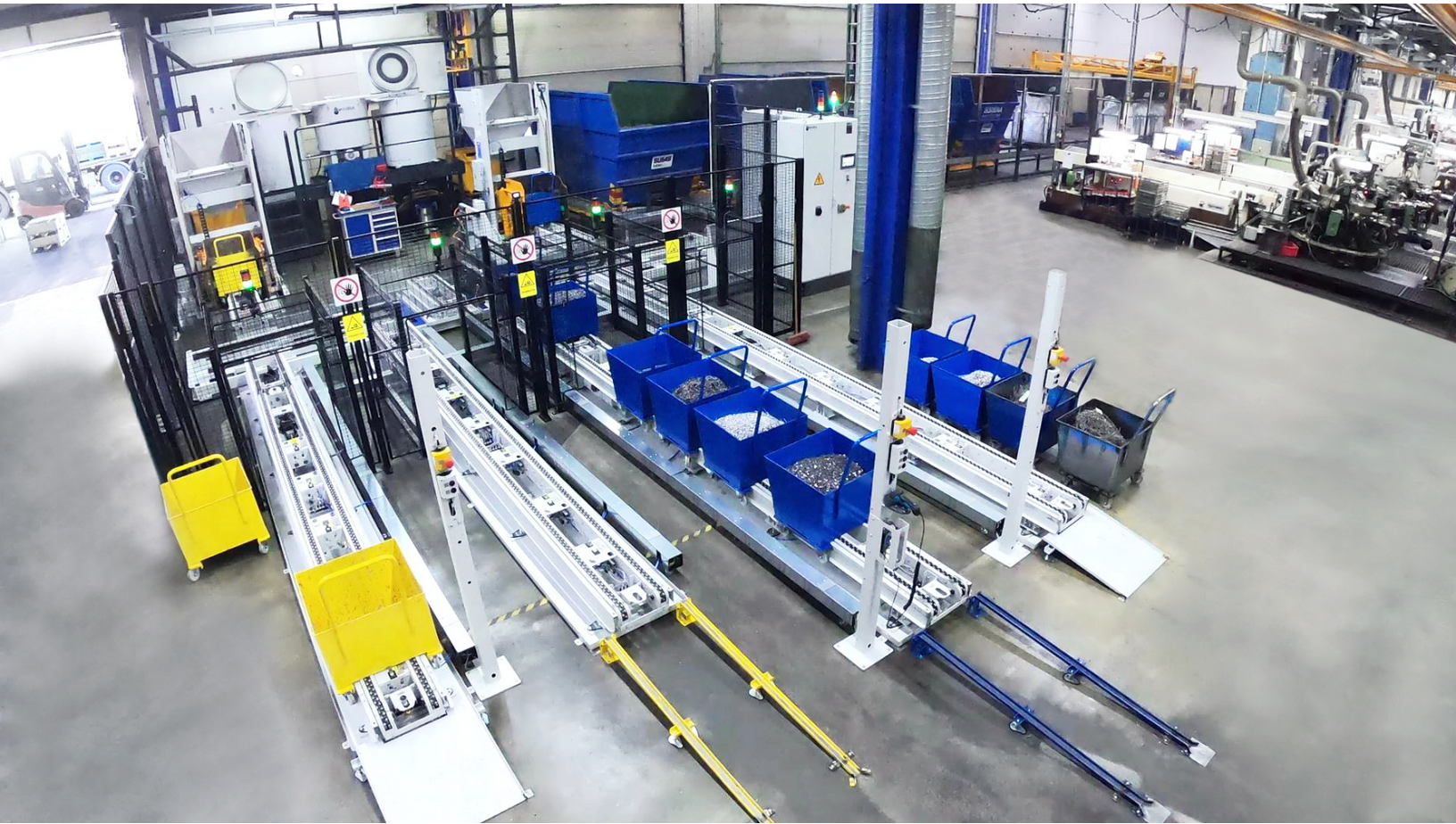
Spåncentrifugeringsanläggning hos Bufab Lann i Värnamo
